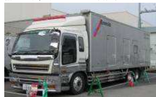
追加配備した高圧発電機車（写真は1,000kVA）
