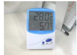
見やすい位置に室温計を設置
