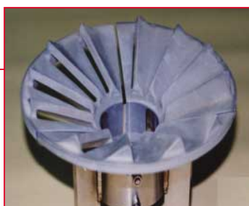
写真2 セラミックス製保炎器
