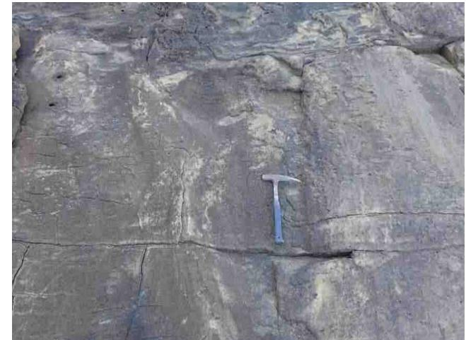
P1 防波壁西端部全景 岩着部は火山礫凝灰岩,  $C_M \sim C_H$ 級岩盤からなる。
