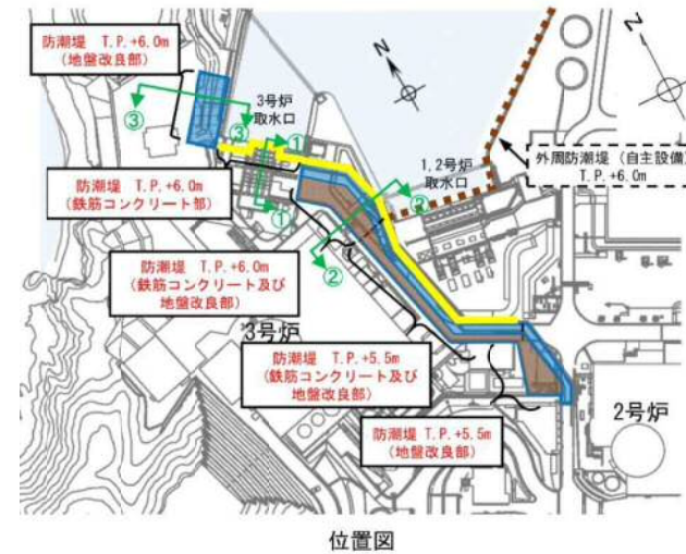
美浜発電所 防潮堤（鉄筋コンクリート及び地盤改良部）
