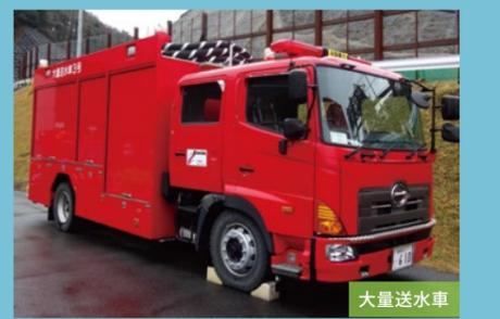
原子炉や燃料プールを冷却し続けられるよう、冷却手段を多様化しています。
