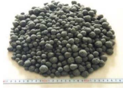
石炭灰造粒物（環境改善用） （外観：粒度 3～40mm） 土粒子密度：2.1～2.4g/cm 3 ： 自然砂（2.6～2.8）より軽量
