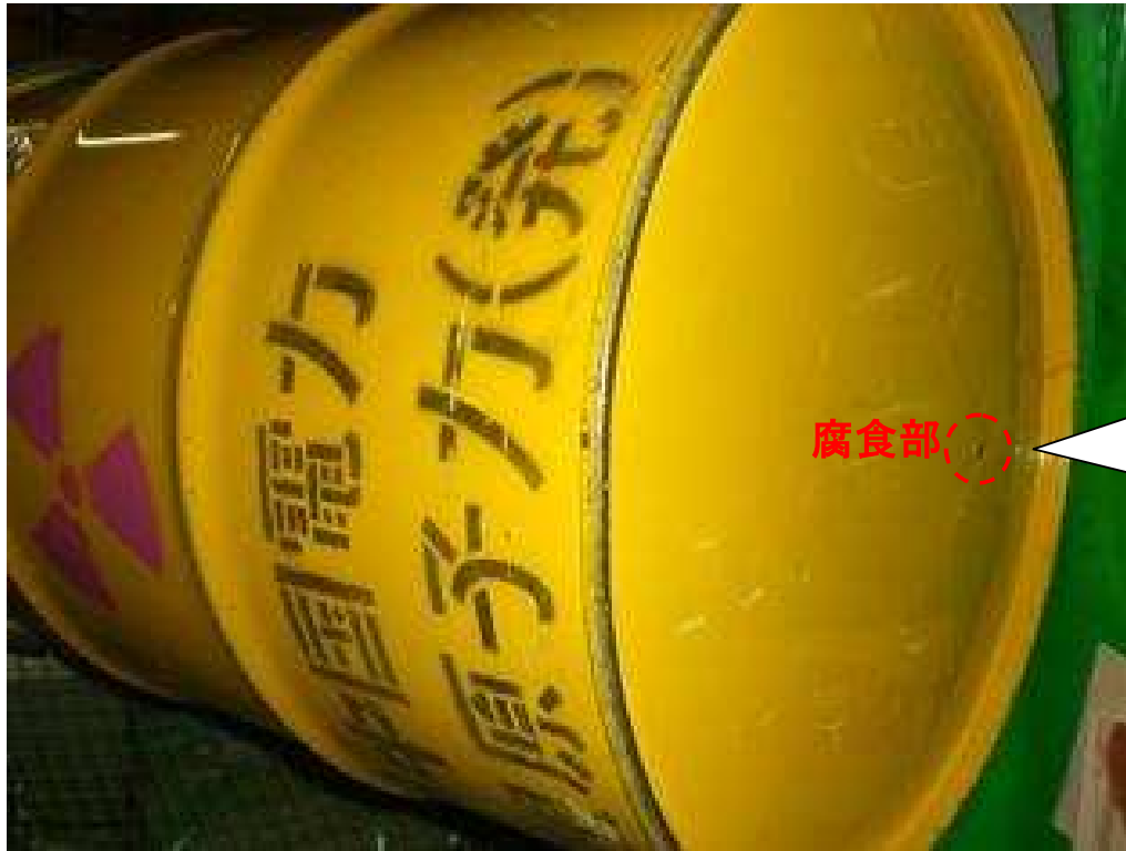
▲腐食ドラム缶 底面
