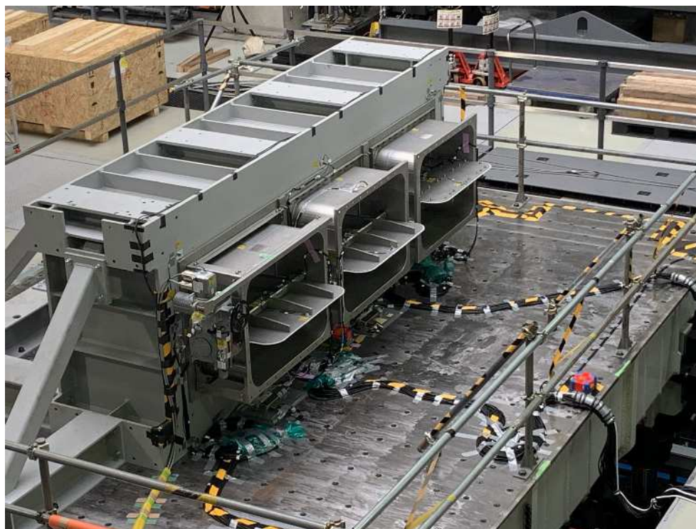
図2 加振試験時の状況写真 (3連ダンパ取付時)
