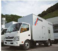
高圧発電機車
