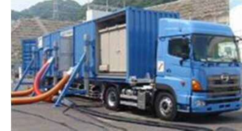
移動式代替熱交換設備
