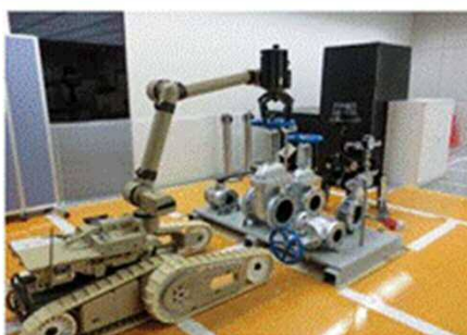
バルブの開閉操作
