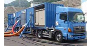
移動式代替熱交換設備
