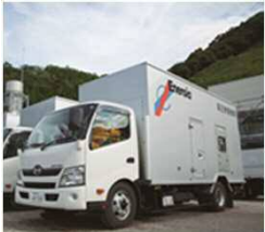
高圧発電機車
