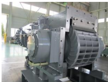
クロスフロー水車 (中低落差用)
