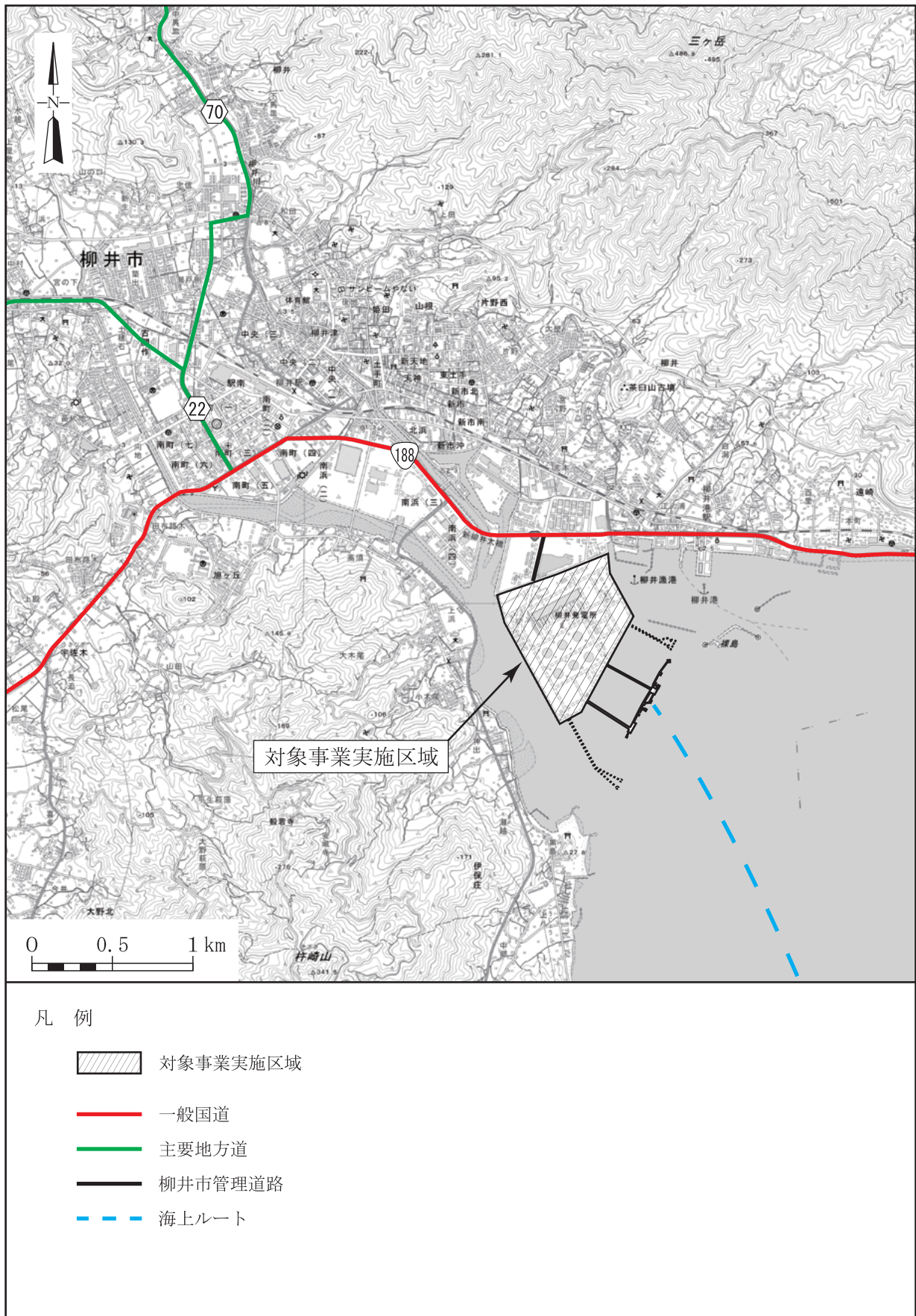
第2.2.6-2図 工事中の主要な交通ルート
