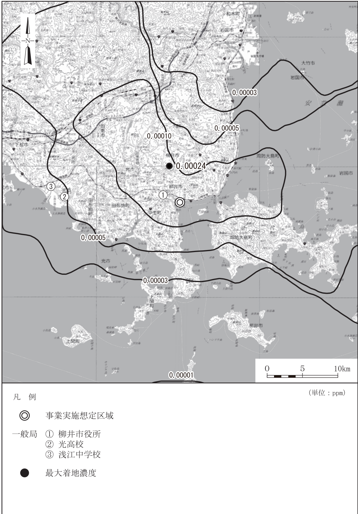
第4.3.1-3図 (2) 二酸化窒素の地上濃度の予測結果 (B案: 新設煙突高さ90m)
