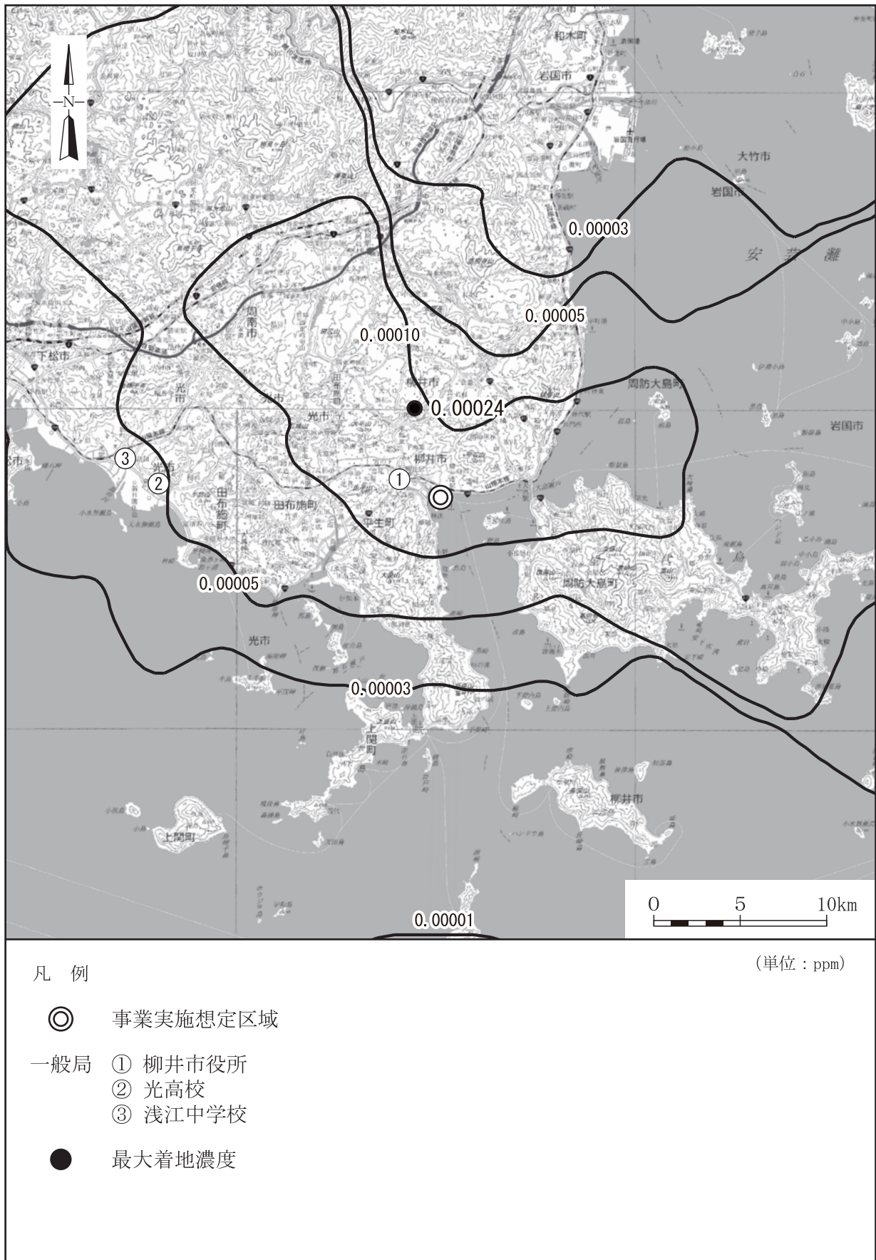
第4.3.1-3図 (3) 二酸化窒素の地上濃度の予測結果 (C案：新設煙突高さ100m)
