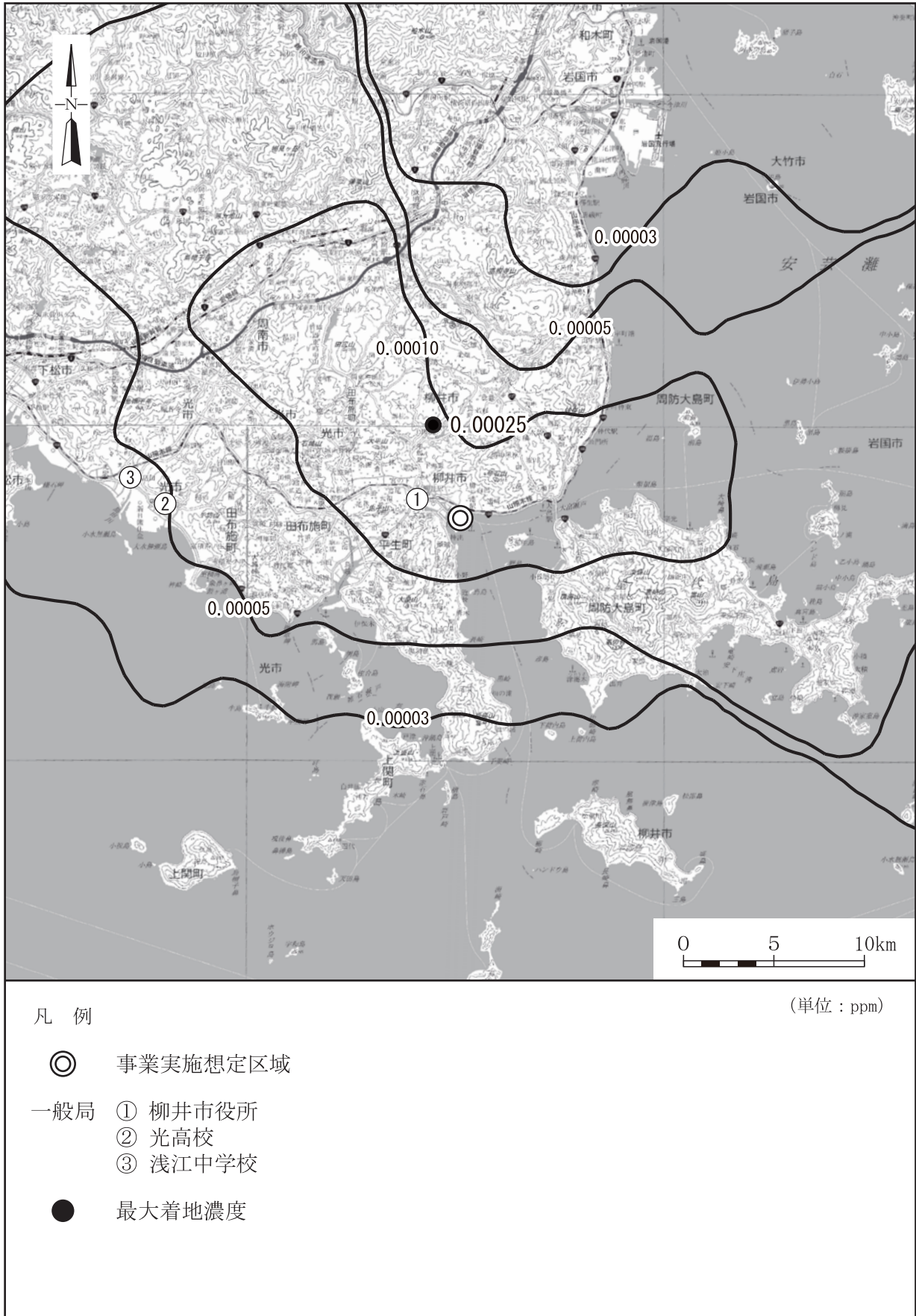
第4.3.1-3図 (1) 二酸化窒素の地上濃度の予測結果 (A案：新設煙突高さ80m)
