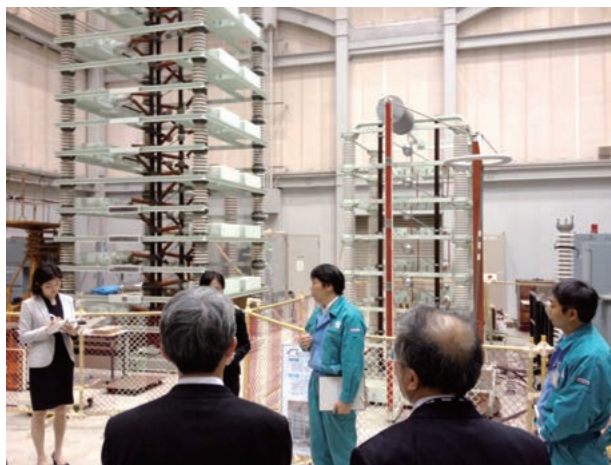
写真2 雷インパルス発生装置
