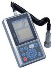
振動診断装置の例 (JFEアドバンテック社製)
