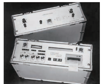
CVケーブル活線診断装置の例 (フジクラ社製)
