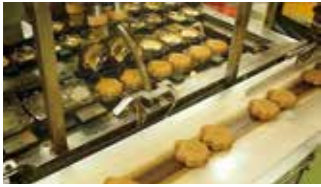
1時間に約2,300個を製造する回転式自動焼き機 写真提供：株式会社やまだ屋
