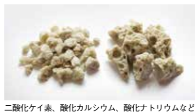
二酸化ケイ素、酸化カルシウム、酸化ナトリウムなどから構成されるポーラスα
