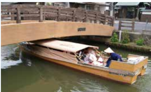
稲新米子橋の橋桁に合わせて船の天井が下がる 写真提供：公益財団法人松江市観光振興公社
