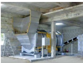
沖縄の離島で家畜糞を有効活用すべく導入された堆肥化用の混合装置「Cモード」 写真提供／株式会社ミライエ
