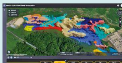
株式会社EARTHBRAINのサービス「スマートコンストラクション」は、デジタルツイン上で最適な土量配分計画や施工手順、建機・トラックの稼働率などを算出し、精度の高い施工計画を短時間で作成する
