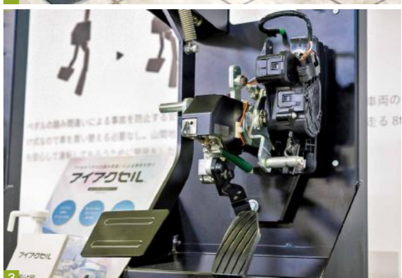
1 段差やカバーのないバリアフリー設計の「ゼロフラップ」。フラップ板を押し下げられないようにすることで不正出庫を防止 2 ボラードを個人向けに開発した電動式の自動車盗難防止装置「i/lock」。バリアードの上昇・下降は小型リモコンで操作し、足などが挟まれないような安全機能も備えている 3 国土交通省認定の後付け安全運転支援装置「アイアクセル」。パニックを起こしたときにアクセルペダルを強く踏み込んでも車が加速せず、ブレーキが緩やかにかかる
