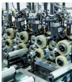
冷間ロール成形機に組み込まれるフォーミングロール
