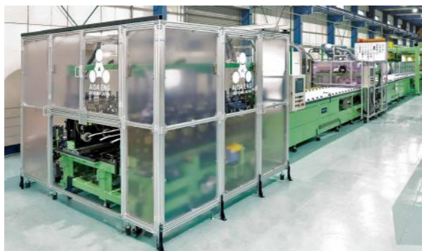
基幹製品の冷間ロール成形機・造管機。コマ状の金型（フォーミングロール）を並べた隙間に帯状の鋼板を通すことで、さまざまな形に効率よく成形する。成形品は建築や自動車、鉄鋼など幅広い分野で利用されている
