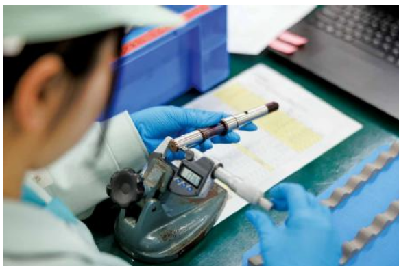
ステンレス鋼の中でも特に加工が難しいとされる析出硬化系ステンレス鋼 SUS630（H900）の精密シャフト円筒の仕上げ加工
