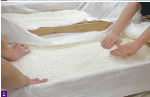
4 こうじ造りは2日間に分けて行われる。1日目は、蒸し上がった米を適度に冷まして麹室(こうじむろ)に入れ、床(とこ)と呼ばれる台の上に広げて種こうじ(こうじ菌の胞子)をまく。蒸米は保温・保湿のため布に包まれて床の上で1日目を過ごし、その間にこうじ菌の胞子が発芽する 5 2日目になると、製麹(せいぎく)中のこうじは麹箱などの木箱に移される。こうじ菌の菌糸が成長し、熱を発生するので温度が上がり過ぎないようにコントロールする。こうじの温度が40~43℃になり、蒸米を麹室に入れてから43~45時間ほどたったらこうじが完成する
