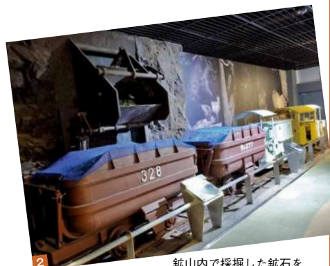
鉱山内で採掘した鉱石を運搬した坑内電車
