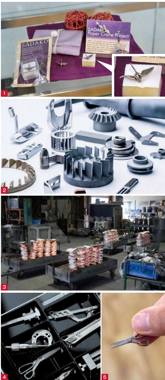
1 G7広島サミットで各国首脳らに贈られた折り鶴「SADAKO」。原爆の子の像のモデル・佐々木禎子さんが病床で折った紙の折り鶴を3Dスキャンし、ステンレスで原寸大に再現した 2 複雑な三次元形状も得意とし、鉄系・ステンレス系・銅・アルミなど、さまざまな材質に対応したロストワックス法による精密鑄造 3 溶解炉と焼成炉を備えた「キャストینگ」の現場。完成した鑄型に金属を流し込むと、白色だった鑄型が赤く輝く 4 5 米国特許を取得したMIM技術で製作したマイクロツール。一つひとつの大きさが約25mmの工具セットで実際に使用もできる 写真提供／2・4・5 株式会社キャストム
