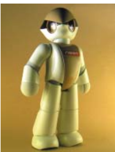
電磁吸着二足歩行機能を搭載した「ネオン」 写真提供：高橋智隆
