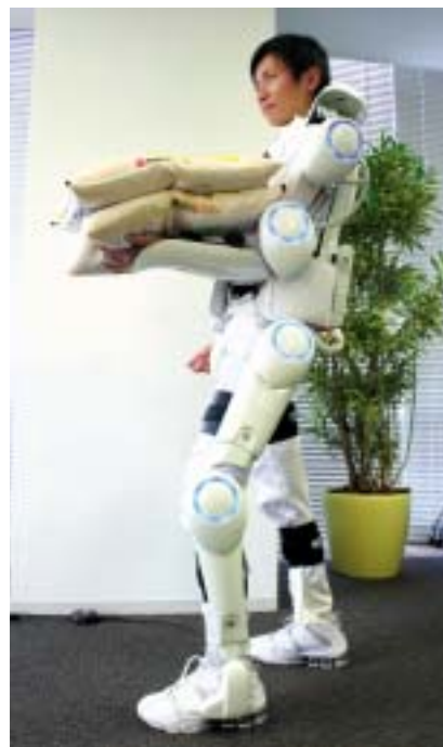
最大で180kgの荷物を運べる「HAL」 写真提供：サイバーダイン株式会社
