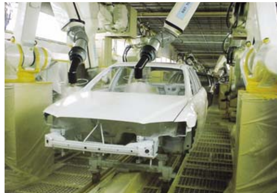
グローバル・スタンダードとなったスリー・ウエット・オン塗装。層をウエットな状態で塗り重ね、1回の焼付・乾燥で仕上げる。
