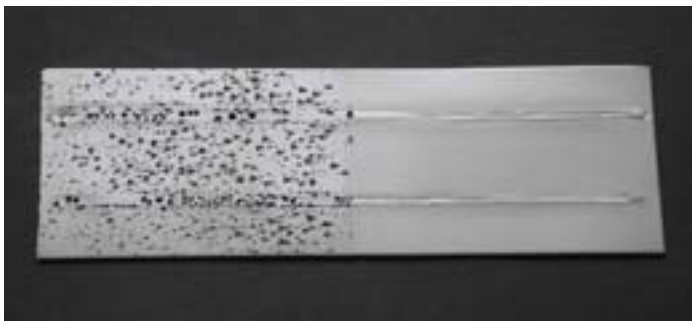
スーパー不動態膜の有無による耐食性の違い (右がケミカル山本のスーパー不動態膜を使用したもの)(写真提供：ケミカル山本)
