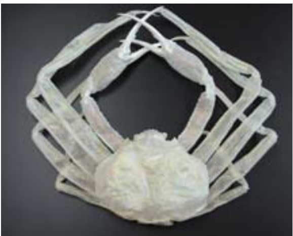
カニの形のままになっているキトサン（写真提供：甲陽ケミカル株式会社）
