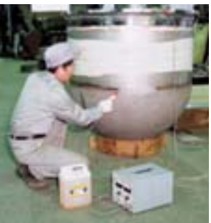
電解方式による焼け取り作業 (写真提供：ケミカル山本)
