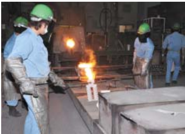
中空になったろう型に金属を流し込む。
