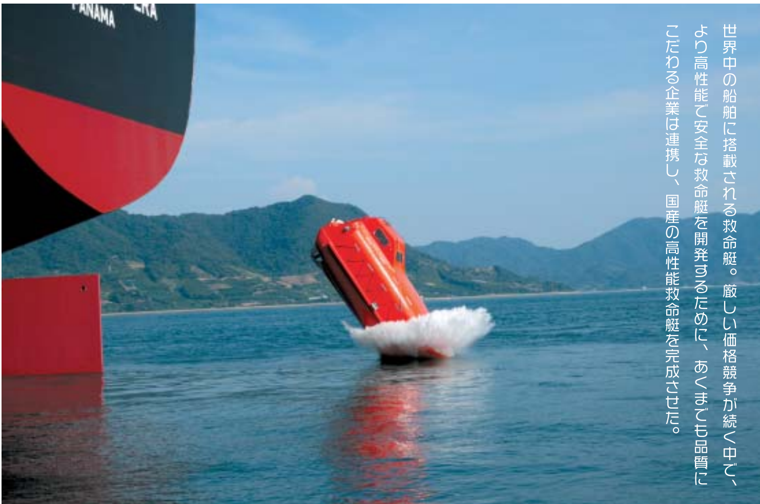
30メートルもの高さから降下するフリーフォール式救命艇（写真提供：ニシエフ）
