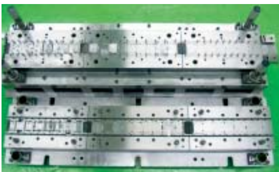
効率的な加工を可能にしたプレス金型
