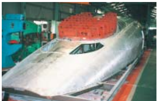
500系新幹線の「顔」作りの工程（写真提供：山下工業所）
