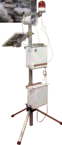
ワイヤーが切れると無線で通信し、サイレンと回転灯が反応する 写真提供:シンク・フジイ
