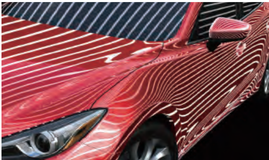
実車に映り込む光の平行線をシミュレート
