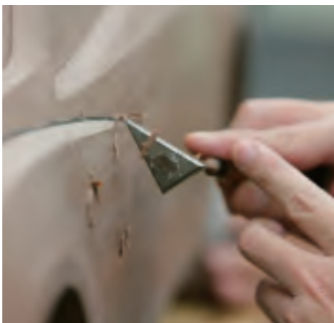
クレイモデルの表面を削るスクレーパー
