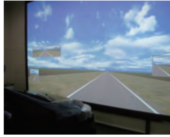
前方のスクリーンに仮想映像を投影し、自動車を使って運動状況を再現。快適・覚醒領域の研究を行う実車シミュレーター 写真提供：ひろしま医工連携・先進医療イノベーション拠点
