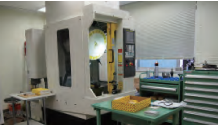
新規医療部材や研究機材などを試作するため、主に金属の微細な二次加工を行う小型マシニングセンタを設置
