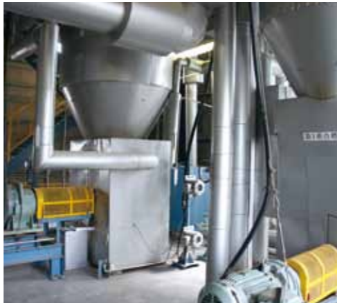
原料のラクタムを重合させる重合塔
