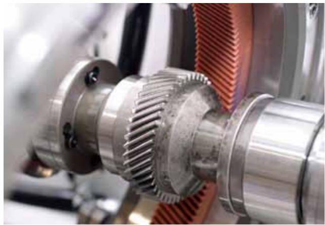
歯車の高精度伝達、ギアノイズの低減を実現したギアホーニング盤 写真提供:清和鉄工株式会社
