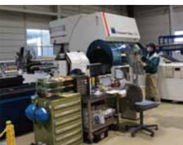
パイプ専用レーザー加工機
