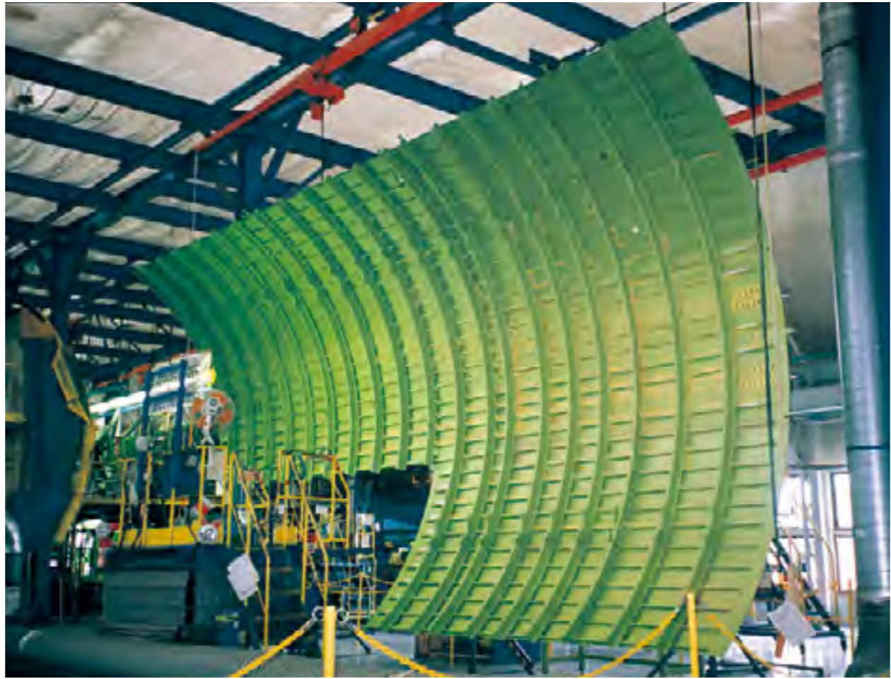
外板と骨格部材などを結合して組み立てられた胴体パネル
