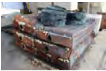
無害化処理した電気機器の金属くず
