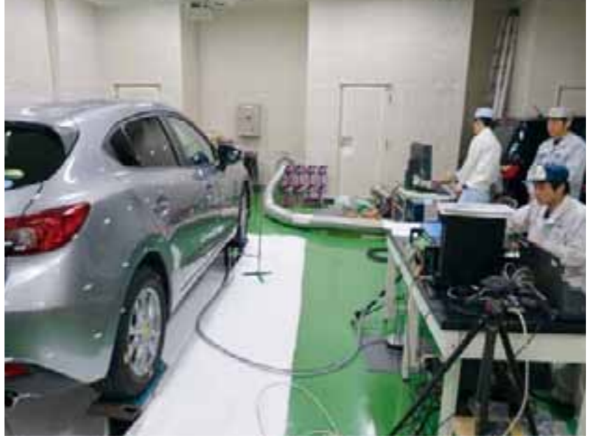
完成車を使った防遮音実験
