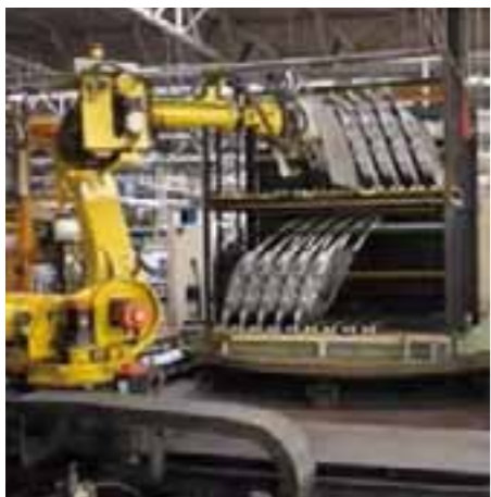
カメラでパレットの位置を認識し、部品を入れていく
