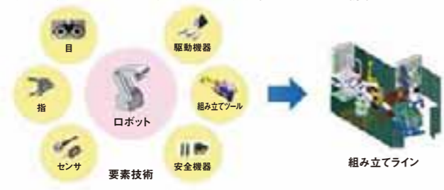
■システム・インテグレーター（Sier）の役割 ピッキング、パレットをばいじめ、ロボットによる無人化生産システムを構築
