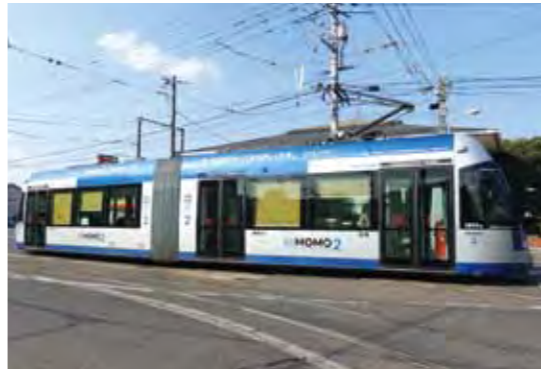
両備グループ・岡山電気軌道の「MOMO」。レール上面から乗降口までの高さがわずか30cmの超低床電車 DESIGNED BY EIJI MITOOKA+DON DESIGN ASSOCIATES(上・右)
