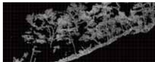
低高度のレーザー計測で樹木の下での地形を精密に捉えられるようになった 画像提供:ルーチェサーチ株式会社
