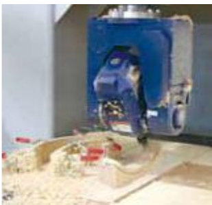
5軸のNC加工機。XYZ軸に回転軸が2軸付加され、複雑な動きで木材を加工する
