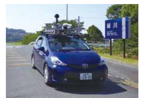
同社で導入しているMMS（モービルマッピングシステム）は、自動車にカメラと三次元レーザーキャナを搭載し、道路や周辺環境の映像や三次元データを取得する方法。ICTを活用した建設生産プロセス「i-Construction」の一環であり、こうした技術を生かしてSDGs「9 産業と技術革新の基盤をつくろう」に取り組んでいる
