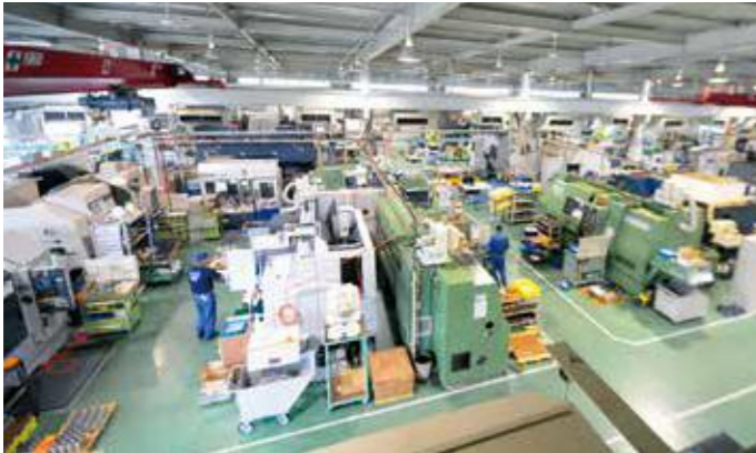
空調を完備し、通路と作業エリアを計画的に区切り、工作機械を効率的に配置した工場内。全社をあげて、5S活動(整理・整頓・清掃・清潔・しつけ)を推進し、設立時の美観を維持している 写真提供:株式会社ひびき精機
