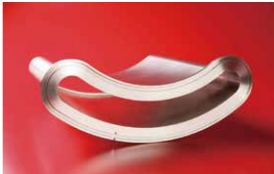
300mm×350mm×80mmのアルミの角材から削り出した半導体製造装置真空部品。肉厚3mm。切削の際、被削材が共振して振動が起こり、削り目が荒れやすくなるこの難削材をスムーズに仕上げられるのがひびき精機の技術力の証しである 写真提供：株式会社ひびき精機
