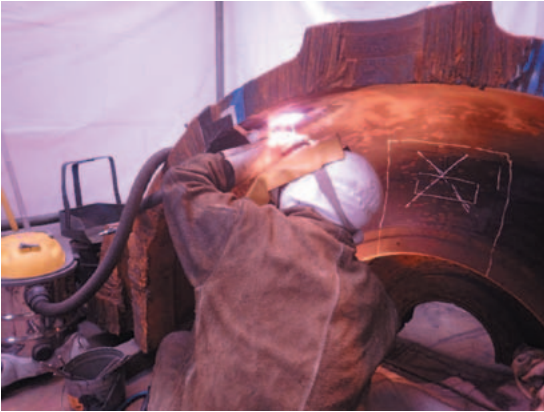
図4 車室廃棄材を用いた実機模擬試験
