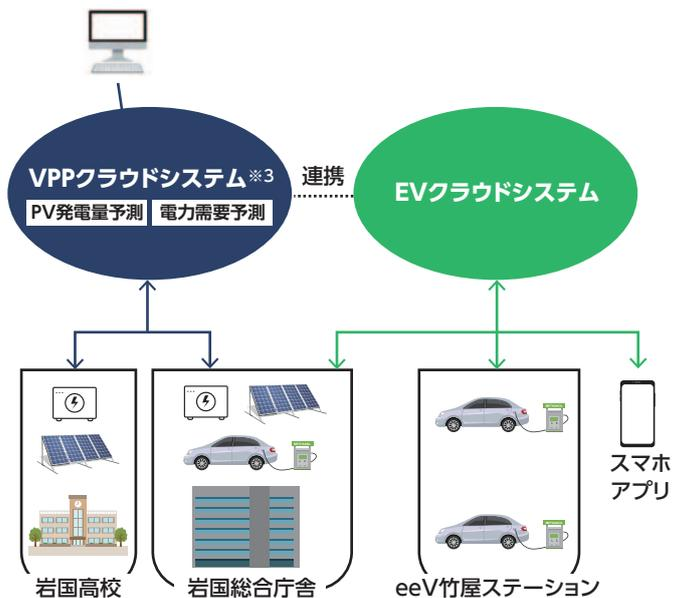
図1 制御システム構成図 (注)
