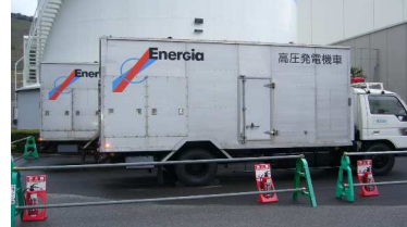
高压発電機車(500kVA 2台)
