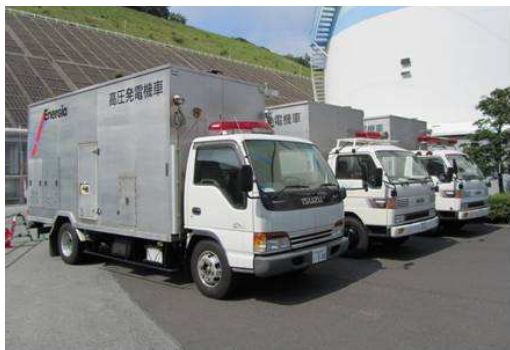
[写真] 高圧発電機車
