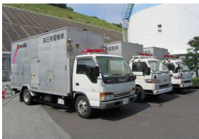
[写真①] 高圧発電機車
