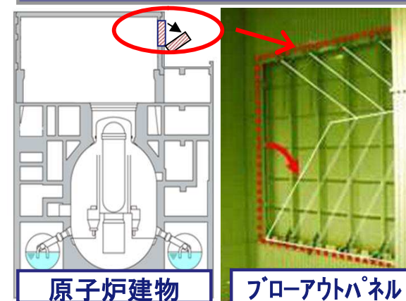
水素放出設備
