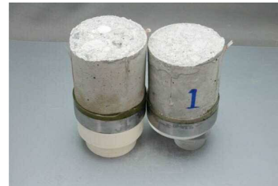
試験後の破断面の状況の例 (レベルコンクリートー基礎コンクリート)
