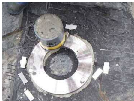
試験後の破断面の状況の例 (黒色頁岩-レベルコンクリート)
