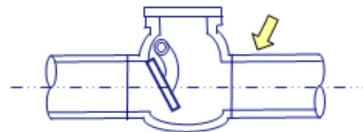
スウィング型逆止弁下流部
