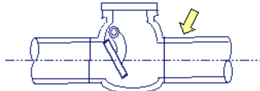
スイング型逆止弁下流部
